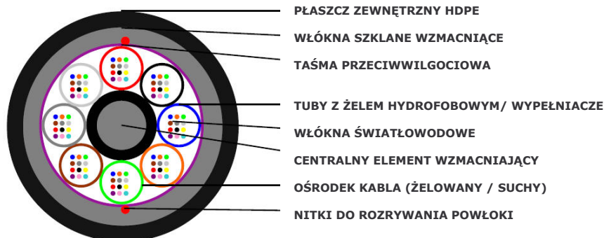
Konstrukcja typowa (do 96 włókien)
